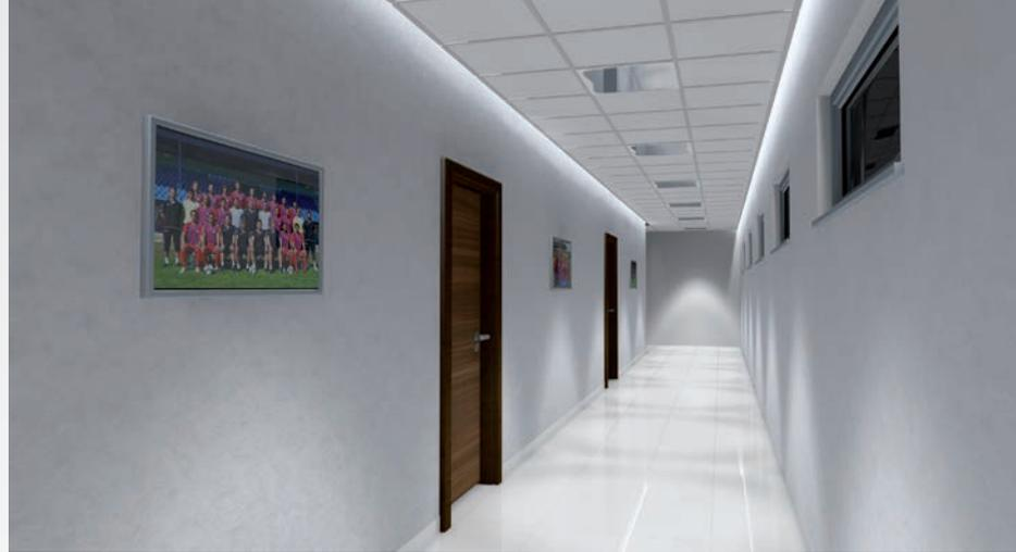
Los detectores de movimiento y el sensor de luz diurna pueden generar ahorros relevantes. El uso del detector de movimiento dependerá cuán frecuentemente se utiliza dicho corredor. Mientras menos se utilice, mayores son los ahorros que se pueden lograr. El propósito de un detector es similar a aquellos que se utilizan en las bodegas: cuando está vacía, la energía que se usa debiera ser mínima.
